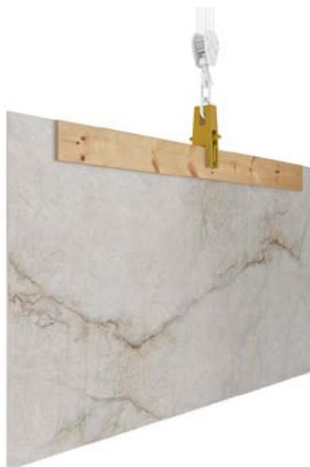
In mancanza di una **pinza** doppia è possibile utilizzarne una **singola**, avendo cura di ampliare il suo piano di ancoraggio con un un asse di legno di 300x20x2 cm. L'accorgimento è necessario per evitare movimenti rotatori o torsioni che potrebbero causare la rottura delle lastre.
